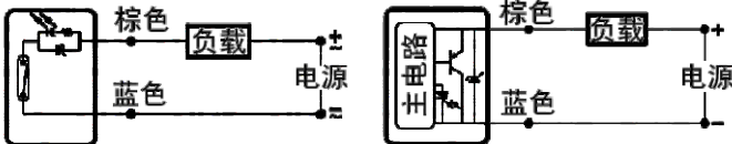
有接点两线式 FSW-A93/T0H/Z73 共地接法
