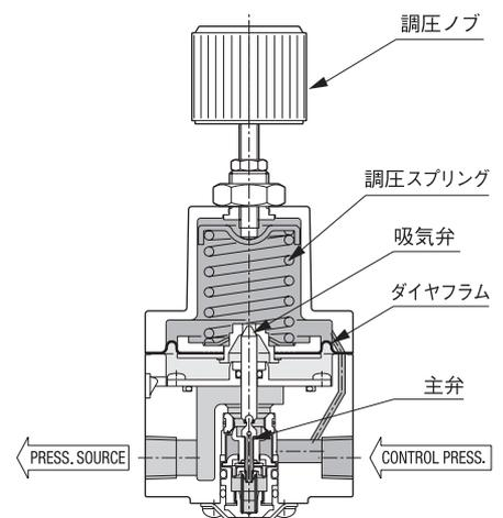
RVは平衡形供給弁を利用しており、調圧ノブを時計方向に回しますと主弁が開き、2次側の真空圧が高くなります。
