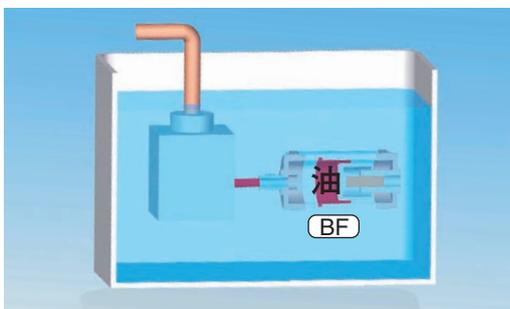
海中などの設置された装置の作動油が熱膨張した際、その体積変化分を吸収しつつ海水とのバランス取る装置
