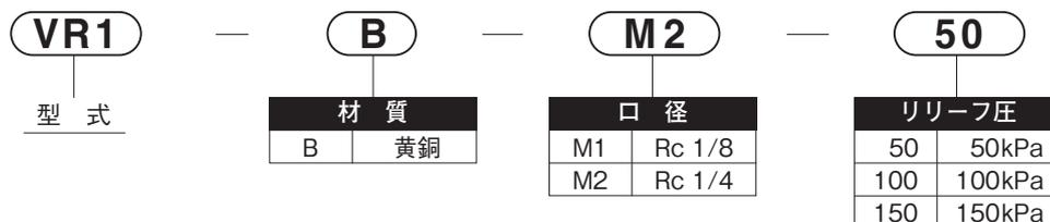
※ オプションとして口径がRc 3/8, M5 のような、標準仕様以外の口径にも対応いたします。
