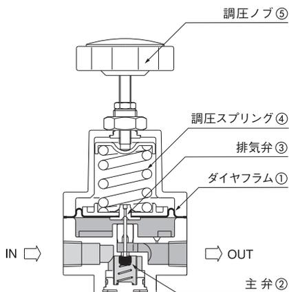
調圧ノブを⑤回しますと、主弁②が開き1次側より流入した供給圧力は2次側へ流入します。
