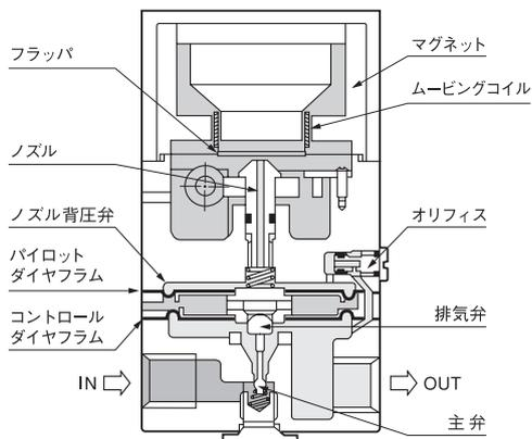
入力信号が増加するとコイルの出力が増加し、フラップを押し下げます。フラップとノズルの間隔が狭くなり、ノズルの背圧が上昇します。これにより、パイロット圧が上昇し、主弁を開き2次側圧力を上昇させます。コイルの出力と、ノズルの背圧による受圧力+フラップの反力が力平衡した時点で2次側圧力の上昇が止まり安定します。以上の動作により、電気信号の大きさに比例した空気圧力を2次側へ発生させることができます。
