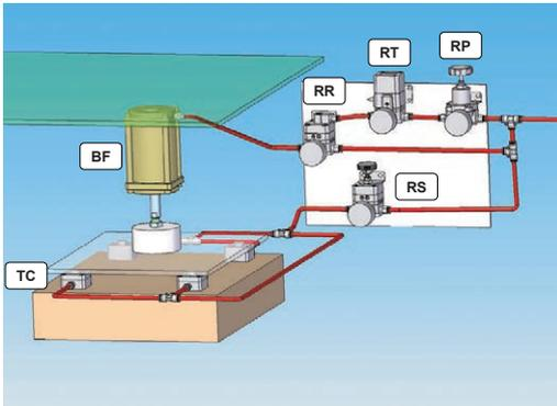
ワークをある力でターゲットに押し付けつつ衝撃に対しては吸収して和らげる装置
